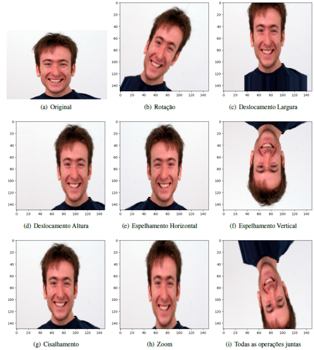
Fig. 3. Exemplo de operações de data augmentation . Fonte da imagem Original: banco de dados WSEFEP [13].
