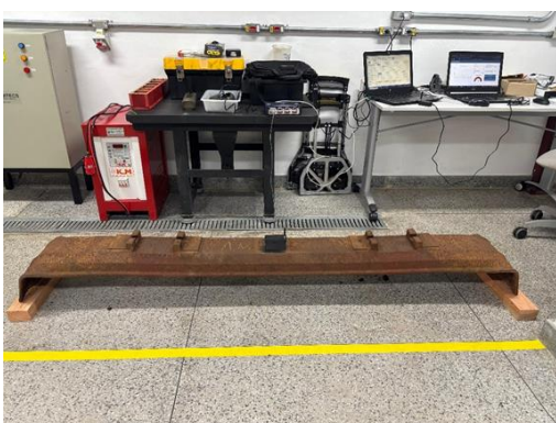
Fig. 3. Dormente de aço sem dano estrutural e nó sensor instalado.
