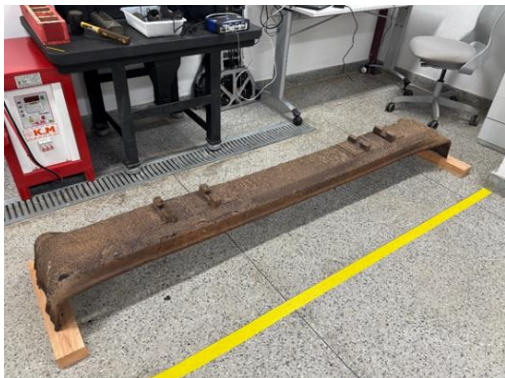
Fig. 2. Dormente de aço com dano estrutural.
