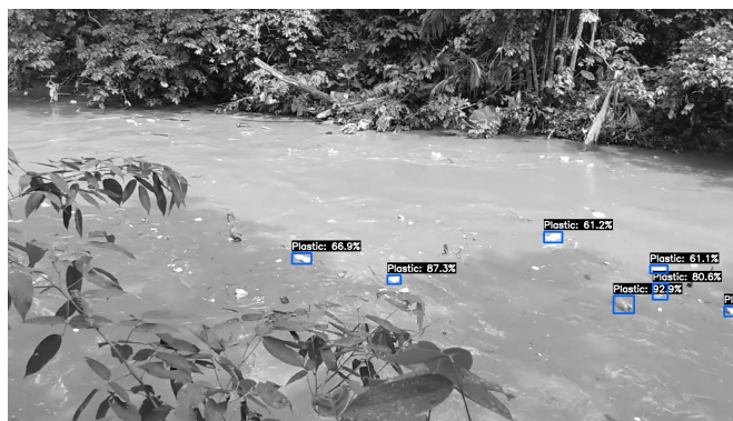
Fig. 7. Teste de inferência utilizando ensemble com Cascade-RCNN + Faster R-CNN aplicado a uma imagem registrada em um igarapé transbordado em Manaus.
