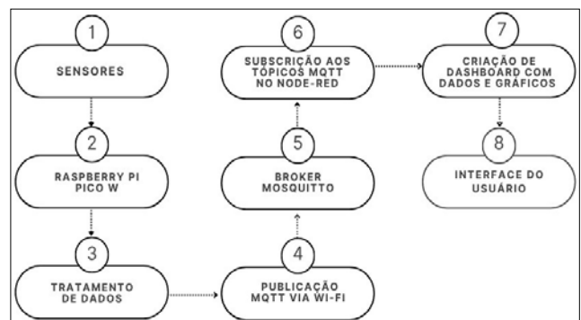
Figura 1. Arquitetura do Sistema de Monitoramento Industrial com MQTT e Node-Red. Fonte: elaborado pelo autor.
