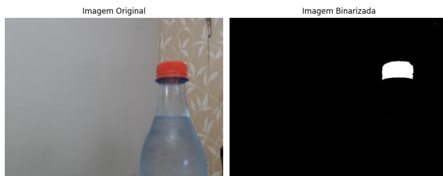
Fig. 3. Exemplo de imagem original e correspondente máscara binária obtida por limiarização em HSV.
