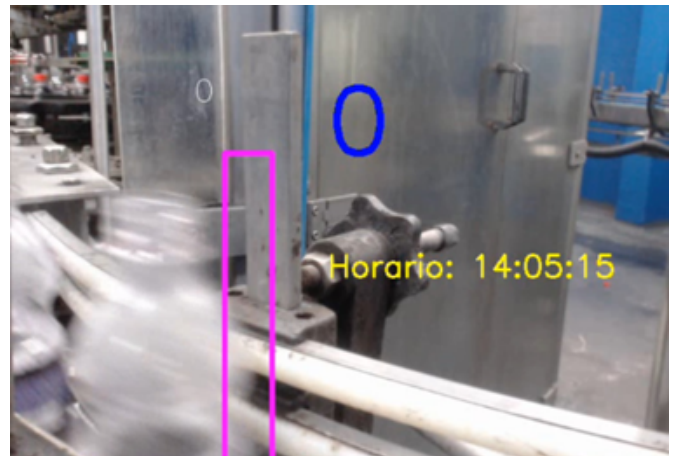
Fig. 4. Implementação final do sistema em ambiente fabril, com sobreposição da contagem e detecção de garrafas.
