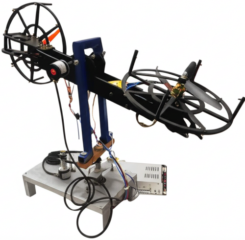
Fig. 1. Sistema aerodinâmico de duplo rotor construído para aplicação das técnicas de controle baseado em dados.
