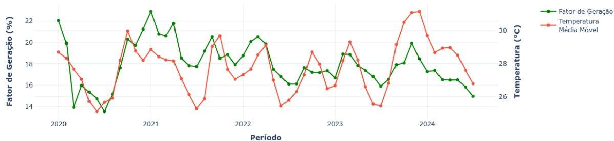
Fig. 3. Fator de geração versus a média móvel da temperatura.
