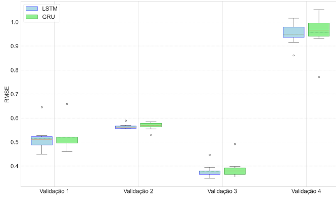
Fig. 9. Comparação do RMSE para v_y nos conjuntos de validação em 10 rodadas de treinamento.
